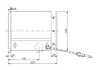
本体材質 鋼板 塗装色 黒 (マンセル N-1.0) 本体質量 2.9 kg 焦点距離 152 mm 平凸レンズ 先玉レンズ D = 89 mm F = 305 mm元玉レンズ 平凸レンズ D = 89 mm F = 305 mmSC-II, CE-II, DE-II, RE-II, XE-II, HA適合器具
