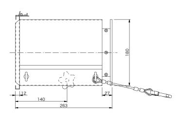
本体材質 鋼板 塗装色 黒(マンセル N-1.0) 本体質量 3.1 kg 焦点距離 203 mm 先玉レンズ 平凸レンズ D = 89 mm F = 406 mm平凸レンズ 元玉レンズ D = 89 mm F = 406 mm適合器具 SC-II, CE-II, DE-II, RE-II, XE-II, HA
