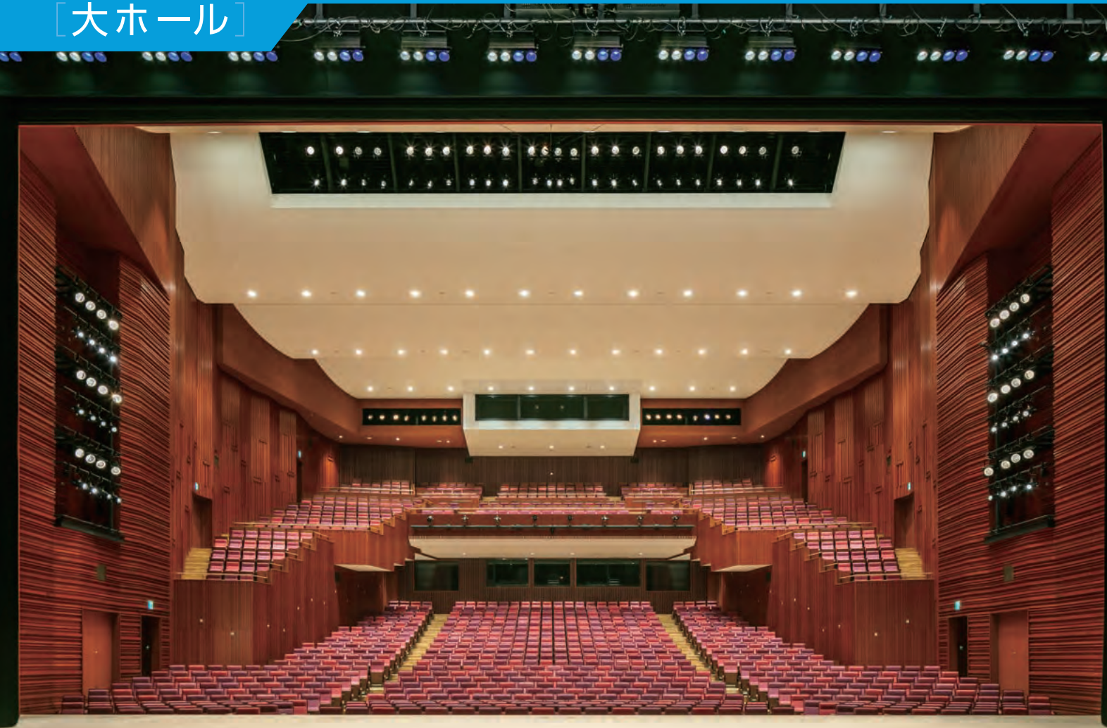
CR-W-LED II -500 (42灯設備) / ハロゲン電球500W相当の明るさ / 定格消費電力83W / 広角タイプ
