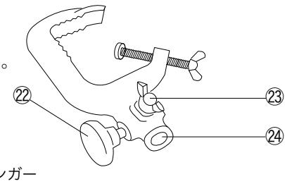
4) ダボ固定ハンドル②を時計回りにまわして、ダボ①を確実に固定します。
