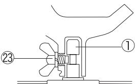
3) 落下防止蝶ボルト③を、スプリングワッシャが平らになるまで時計回りにまわします。ハンガーを持ち、「落下防止が働いている」ことを確認します。
