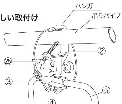
2) ハンガーを吊りパイプに取付け、ハンガー固定蝶ボルト⑤を時計回りにまわして確実に固定します。
