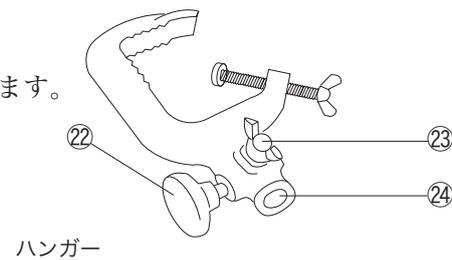
4) ダボ固定ハンドル㉒を時計回りにまわして、ダボ①を確実に固定します。
